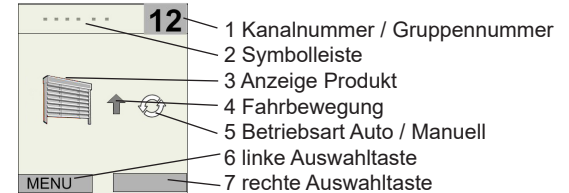
Abb. 1 Display im Betriebsmodus (Beispiel 1): Kanal 12, eingelernte Jalousie, Automatik aktiv, Fahrbewegung AUF
