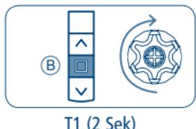
Diese Folge bringt die Markise in die untere Endlage und versetzt den Motor in den Betriebsmodus "Bediener anwesend". Damit kann die Tuchspannung millimetergenau reguliert werden.
