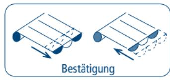
Nach Regulierung und Bestätigung der „Tuchspann- Position“, fährt der Motor in die untere Endlage und danach zur soeben bestätigten Position der Tuchspannung. Ab jetzt führt der Motor jedes Mal diese Option durch. Nach runterfahren auf die untere Endlage, fährt der Motor automatisch auf die „Tuchspann- Position“ zurück.
