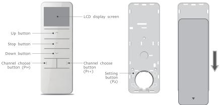
DD2702H 15-channel emitter DD2702H Back
