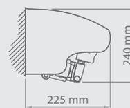
Fixation au mur (option avec un auvent)
